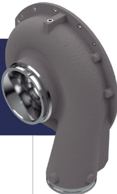
No compressor centrífugo a voluta tem a função de receber todo o fluxo de gás proveniente do impeller e difusor e direcionar esse fluxo para uma única saída. A voluta pode ser fabricada em uma única peça como também pode ser fabricada como um conjunto de peças menores.
